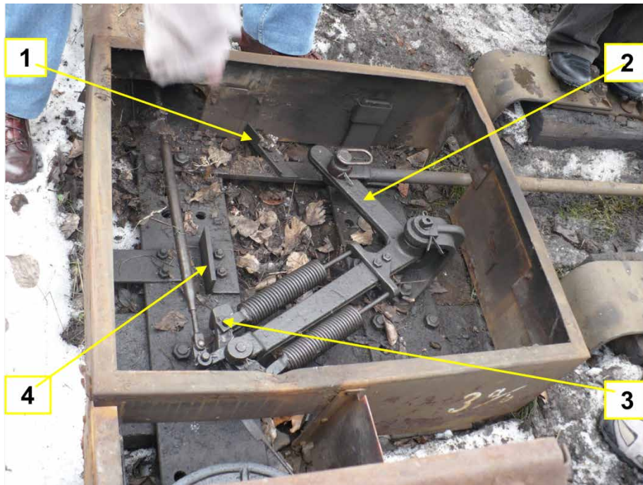
Rys. 48. Mechaniczny napęd zwrotnicowy (bez urządzeń kontroli stanu położenia iglic)
