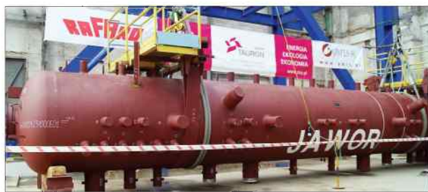
Ważący 53 tony walczak jest częścią kotła, który w przyszłości będzie spalał biomasę
